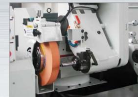
Innenschleifeinrichtung an der GU-35 A
